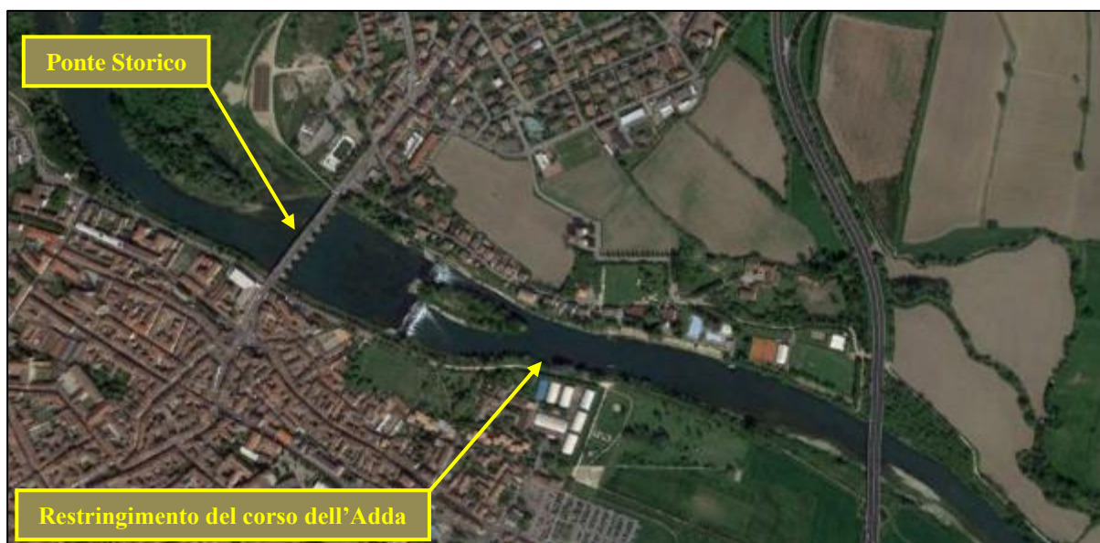
Fig. 6.3: Restringimento d'alveo dell'Adda a valle del Ponte Storico di Lodi
